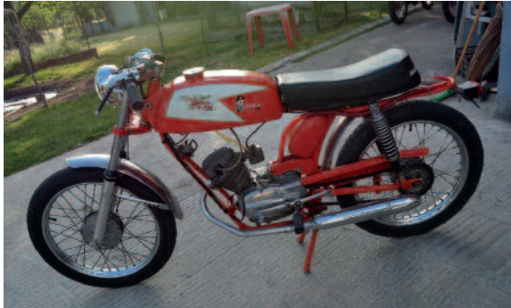
Ciclomotore Morini Corsarino 48 cc La sua particolarità è il motore a 4 tempi
